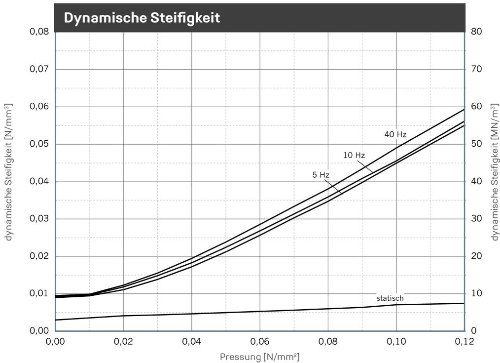
Verlauf der dynamischen Steifigkeit bei sinusförmiger Anregung um eine konstante Mittellast, Wegamplitude  $\pm 0,25$  mm. Probenabmessung 300 mm x 300 mm x 50 mm; Statische Steifigkeit als Tangentenmodul aus der Federkennlinie. Messung in Anlehnung an DIN 53513.
