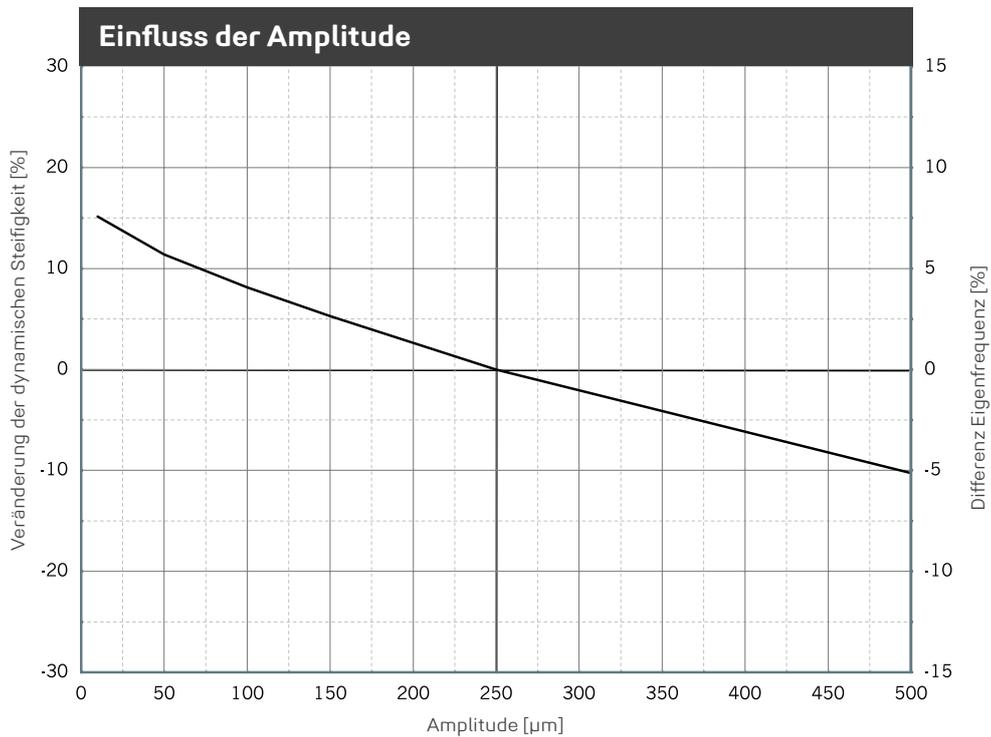
Veränderung der Steifigkeit aufgrund geänderter Amplitude. Mittelwert für 5 Hz, 10 Hz und 40 Hz Anregung. Sinusförmige Anregung bei konstanter Mittellast von 0,10 N/mm<sup>2</sup>, Probenabmessung 300 x 300 x 50 mm. Eigenfrequenz für einen eindimensionalen Feder-Masse-Schwinger auf starrem Untergrund.
