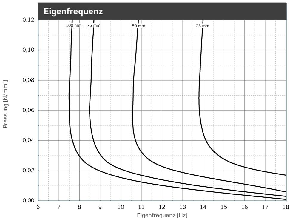
Eigenfrequenzverläufe für einen eindimensionalen Feder-Masse-Schwinger unter Berücksichtigung der dynamischen Steifigkeit von **REGUPOL vibration 450** auf starrem Untergrund. Probenabmessung 300 mm x 300 mm.
